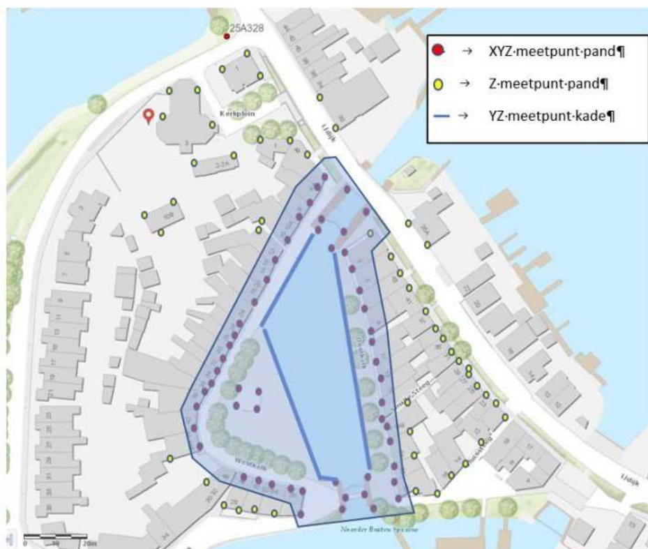
Figuur 3: schematisch overzicht van de meetpunten met in het blauwe kader de actieve zone
