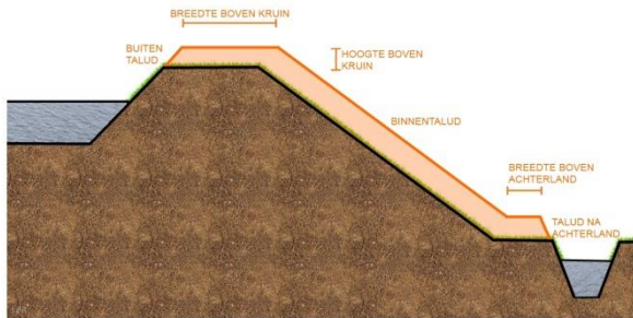
leggerprofiel (zwarte lijn) en profiel van vrije ruimte (oranje lijn)
