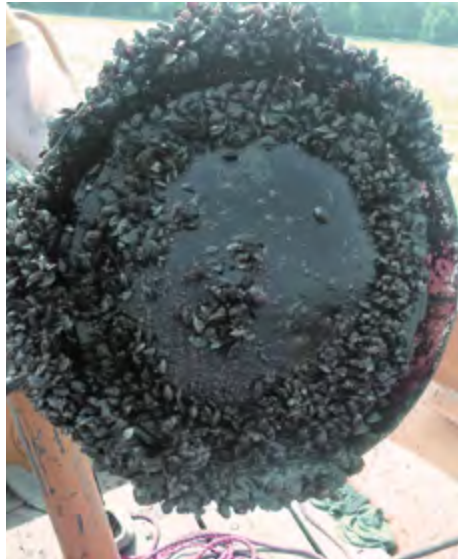
De quaggamossel hecht zich ook op bijvoorbeeld beluchters. Dit zijn onderdelen van luchtmenginstallaties, die zorgen voor beweging in het water om blauwalgen tegen te gaan.
