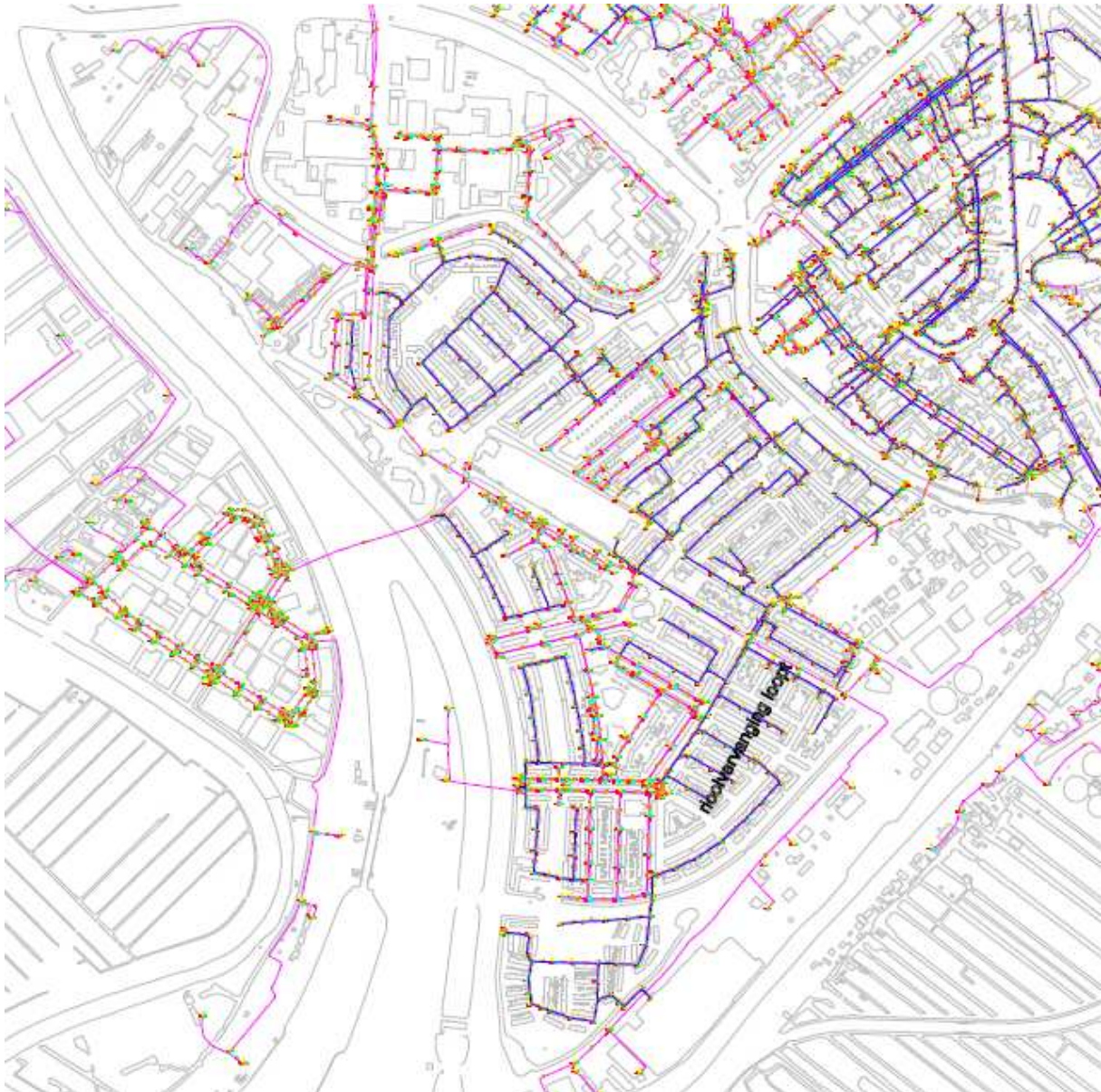
Figuur 3-1: Rioolstelsel Korte Akkeren met het opgeboeide (blauwe) en nieuwe (roze) stelsel (situatie maart 2013)
