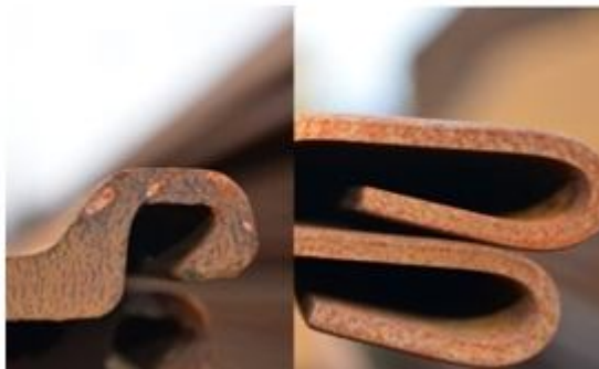
Figuur 11: Sloten warmgewalste (links) en koudgevormde (rechts) damwandprofielen
